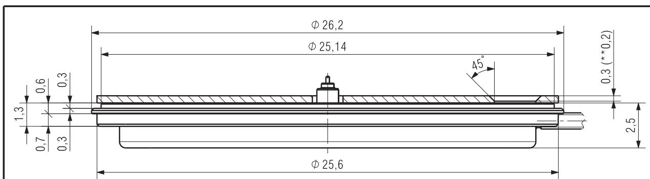
\* L'épaisseur maximum du cadran varie selon la hauteur d'aiguillage (voir plan Aiguillage)
