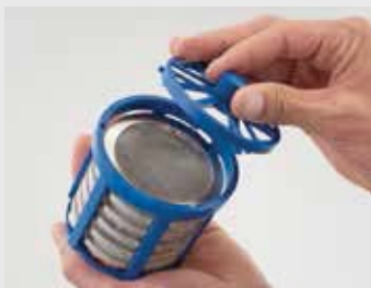
Körbe mit Uhrenteilen befüllen
