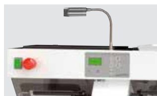
WP-Ex 3000 mit zusätzlichem LED-Spot und Multifunktionsdisplay
