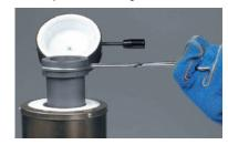
2. Füllen Sie langsam Metall in den Schmelztiegel, bis dieser zu 1/4 - 1/3 gefüllt ist. Beginnen Sie dabei mit kleinen Metallstücken. Wenn das Metall geschmolzen ist, fügen Sie weiteres Metall hinzu, bis Sie die für den Guss erforderliche Menge erreicht haben.
