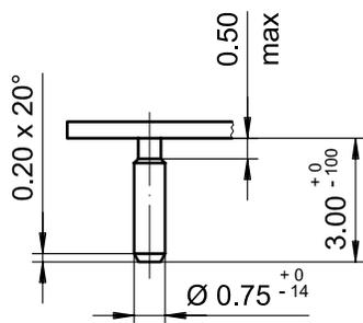
Epaisseur du cadran selon hauteur de l'aiguillage
