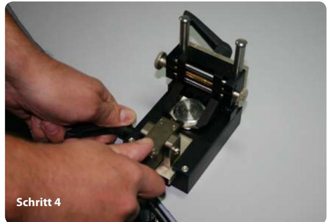
Der Schieber wird so weit zum Gehäuse geschoben, bis das Öffnermesser zwischen Boden und Gehäuse ansetzt. Der Arretierhebel wird fest angezogen.
