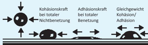
Antispread senkt die Oberflächenspannung des Festkörpers soweit, dass selbst Silikonöl nicht mehr breitleben kann.
