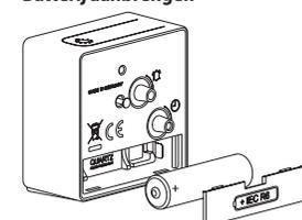
Open het batterij vak aan de achterzijde van de wekker en breng een batterij type AA, LR 6, 1,5 V met de correcte polen aan. Verzeker daarbij dat de ON/OFF schakelaar in de positie OFF staat. Gebruik geen accu's. Lege batterijen niet met het huisvuil verwijderen.
