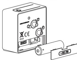
Abra el compartimento de la batería por la parte trasera del despertador y coloque una batería de tipo AA, LR 6, 1,5 V con los polos en la dirección correcta. Al
