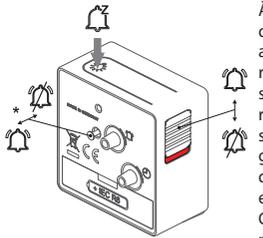
À l'heure de réveil qui a été réglée, une alarme crescendo retentit. Il s'agit d'un signal acoustique de réveil dont l'intensité augmente progressivement afin d'assurer un réveil en douceur. Ce signal de réveil peut être interrompu pendant quelques minutes en appuyant brièvement sur la touche snooze/éclairage située sur la partie supérieure du boîtier. Ensuite, le signal acoustique redémarre (fonction de répétition).
