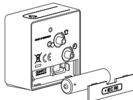
Öffnen Sie das Batteriefach auf der Rückseite des Weckers und legen eine Batterie vom Typ AA, LR 6, 1,5 V polrichtig ein.
