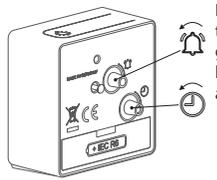
Réglez l'heure correcte en tournant le bouton de réglage avec le symbole de l'horloge situé à l'arrière.
