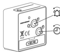
Stellen Sie die korrekte Uhrzeit ein, indem Sie den Einstellknopf mit dem Symbol Uhr auf der Rückseite drehen.
