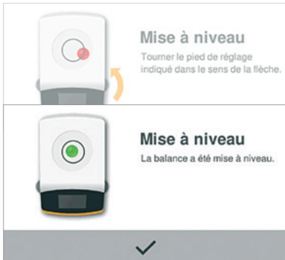
Un capteur optoélectronique intégré dans Secura® contrôle en permanence si la balance est parfaitement à niveau. Si le capteur détecte des écarts, l'affichage vous signale immédiatement le risque présent et vous donne des instructions pratiques pour vous aider à remettre la balance à niveau. L'édition des valeurs de pesée via une interface ou une imprimante est interrompue jusqu'à ce que la balance soit à nouveau correctement mise à niveau.
